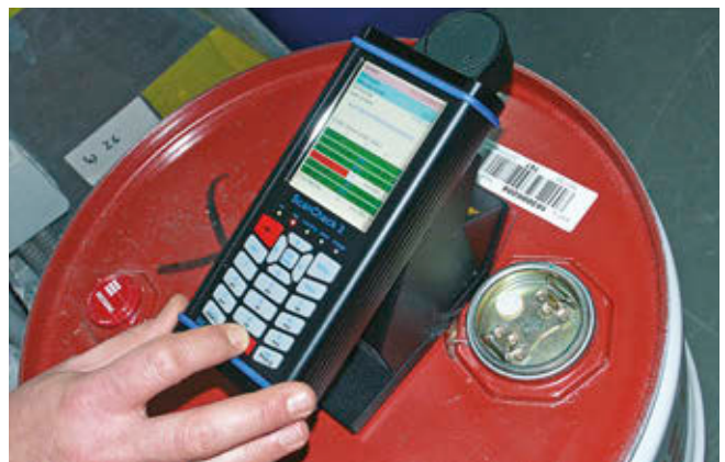
Prüfung von Barcodes auf Blechfässern
