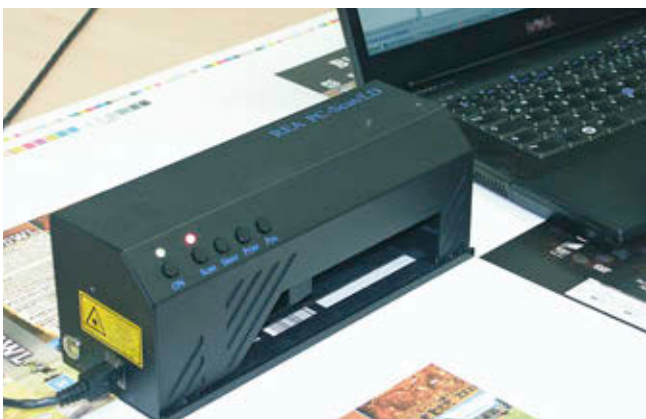
Vermessung von Barcodes auf Druckmusterbogen
